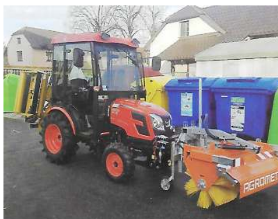
Traktor Kioti s čelním kartáčem na sněh a nepořádek
